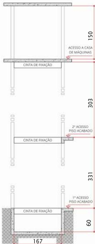
Para a instalação do elevador é necessário a construção de caixa de corrida completamente fechada, com poço, paredes e pontos de fixação ao longo da extensão vertical da caixa de corrida.
